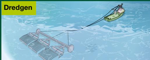
Dredgen sind netzartige Säcke oder – häufiger – Metallkörbe, die auf dem Meeresgrund geschleppt werden. Unten ist eine Klinge angebracht, teils mit Zähnen, die den Boden abschabt.
