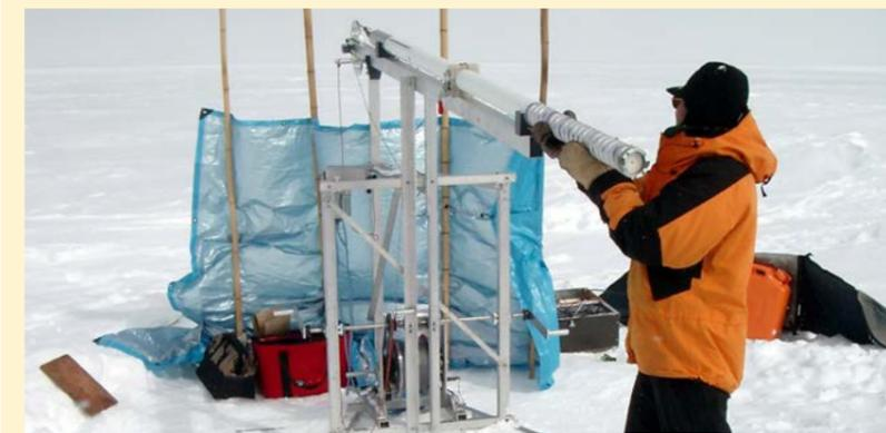
Ein Forscher extrahiert einen Bohrkern aus der grönländischen Eisdecke.
